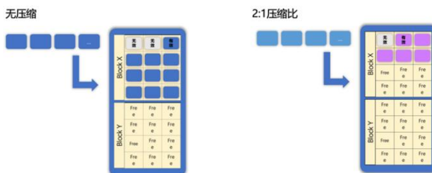
图 3：CSD 降低 NAND Flash 物理空间占用原理示意图
