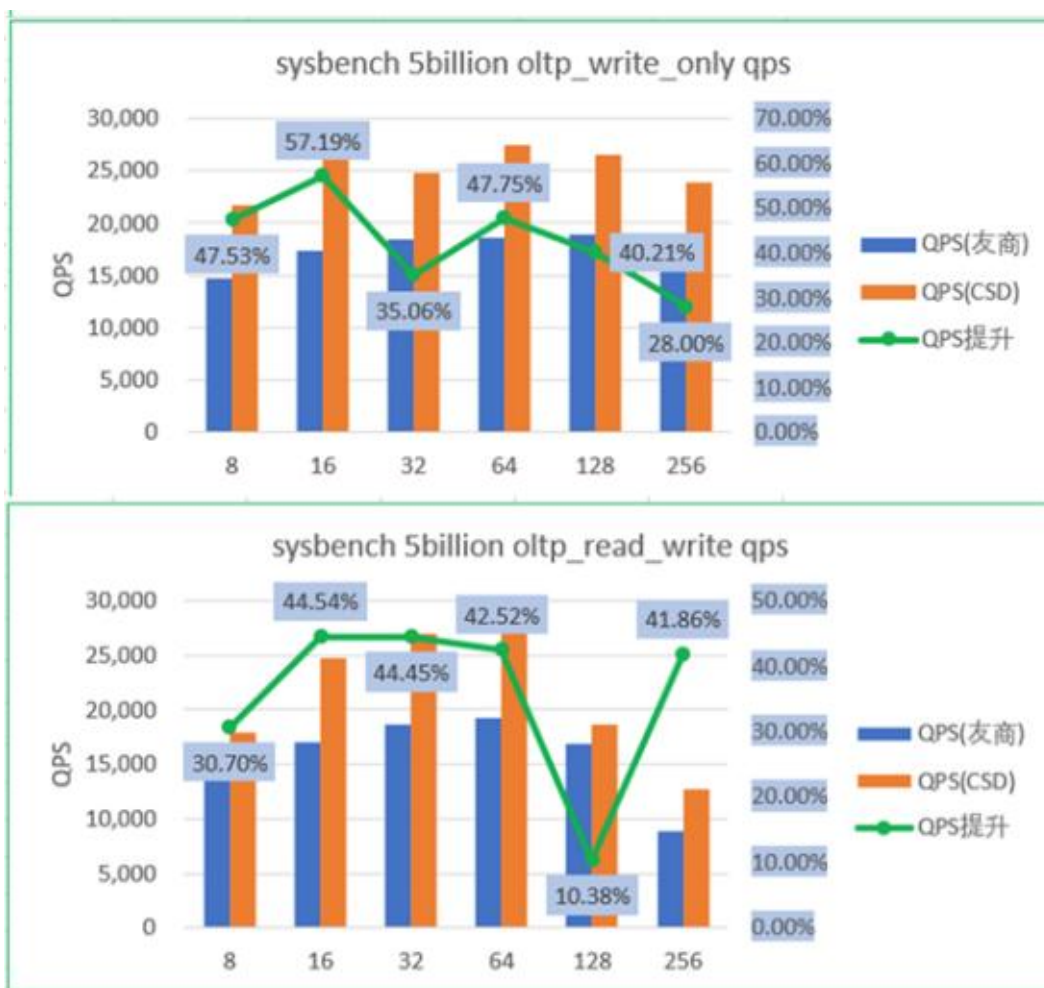
图 10： CSD 与普通 NVMe SSD 的 Sysbench For 达梦数据库性能对比
